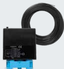
Индукционна намотка Детектор с нормално отворен контакт и превключващ контакт, с регулиране между импулсен и продължителен контакт, разпознаване на посоката, 50 m кабел на намотката
